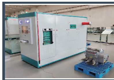
全自动开关设备综合试验系统 Comprehensive testing system for fully automatic switchgear Système d'essai complet pour appareillage entièrement automatique
