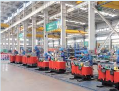
干变装配 Dry-type transformer assembly Assemblage par changement à sec
