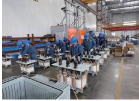
油变装配 Oil-immersed Transformer Assembly Assemblage de changement d'huile
