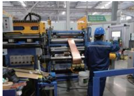
油变线圈绕制 Oil-immersed transformer coil winding Bobine de changement d'huile enroulée
