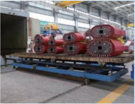
线圈烘干 Coil drying Séchage des bobines
