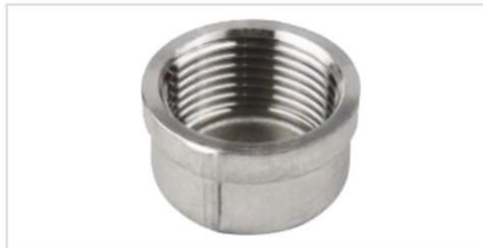
管帽 Pipe cap 材质:不锈钢201/304/316L/2205等 口径:1/8"-4"(DN6-DN100) 压力:PN1.6
