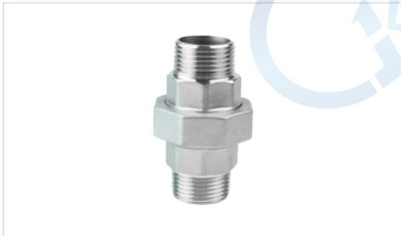
双外丝活接 Double outer wire union 材质:不锈钢201/304/316L/2205等 口径:1/8"-4"(DN6-DN100) 压力:PN1.6
