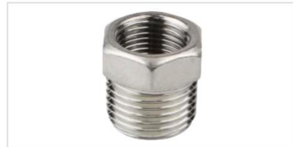
补芯 Bushing 材质:不锈钢201/304/316L/2205等 口径:1/8"-4"(DN6-DN100) 压力:PN1.6
