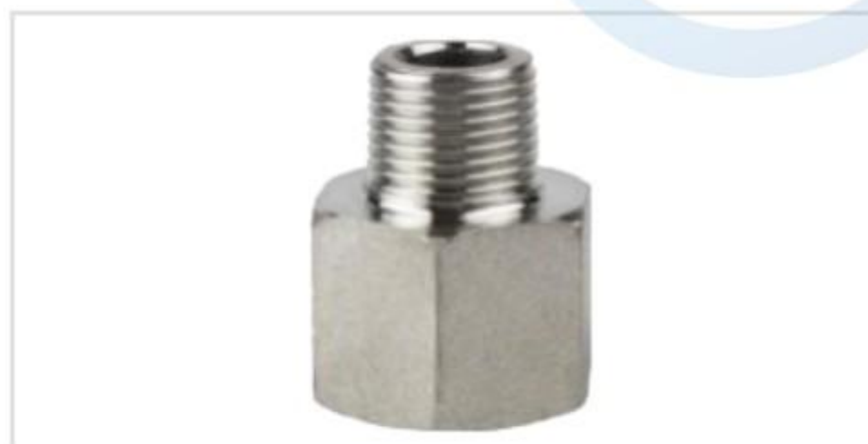
变径六角内外丝 Variable diameter hexagonal inner and outer threads 材质:不锈钢201/304/316L/2205等 口径:1/8"-4"(DN6-DN100) 压力:PN1.6
