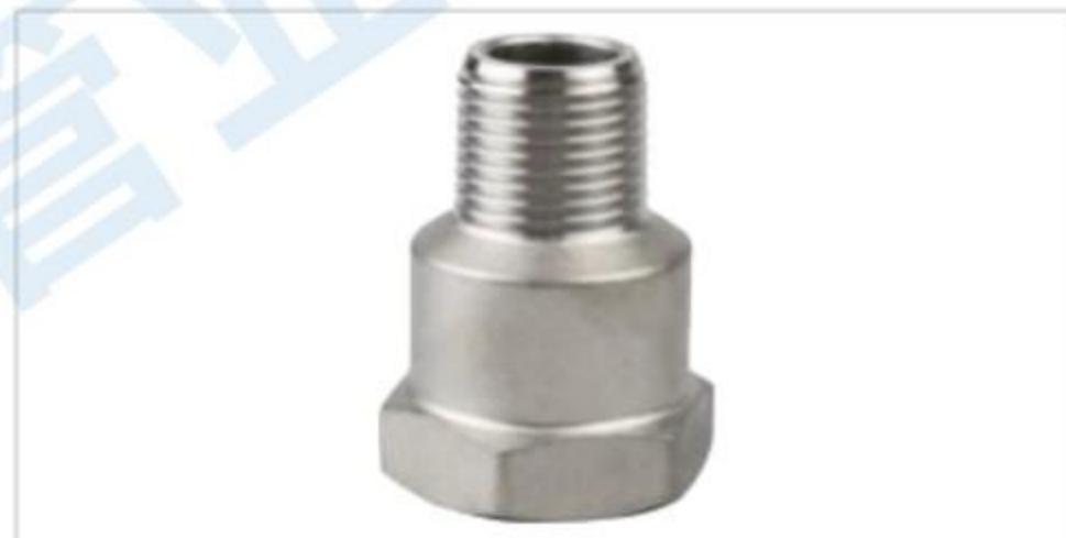
变径内外丝 Variable diameter inner and outer threads 材质:不锈钢201/304/316L/2205等 口径:1/8"-4"(DN6-DN100) 压力:PN1.6
