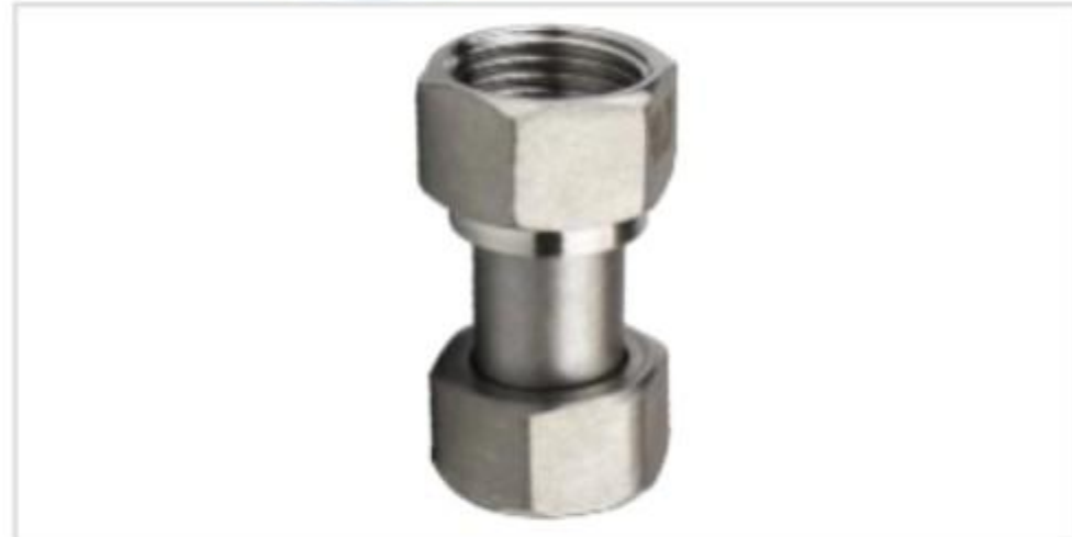
活动内丝 Activity silk 材质:不锈钢201/304/316L/2205等 口径:1/8"-4"(DN6-DN100) 压力:PN1.6
