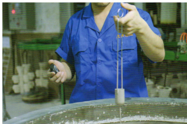
浆浓度测试 Concentrations Test
