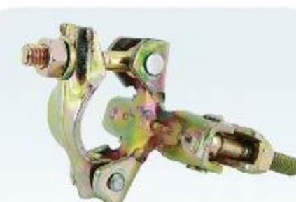
RFH-A043 英式冲压直角扣件 British Type Pressed Double Coupler 48.3mm 0.93kg
