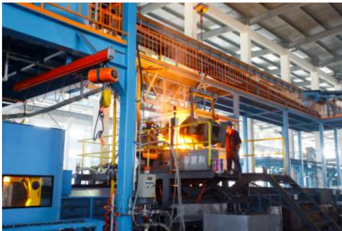
Tundish自动浇注系统 Tundish auto pouring system
