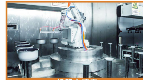
机器人喷房 Robotic Spray Booth
