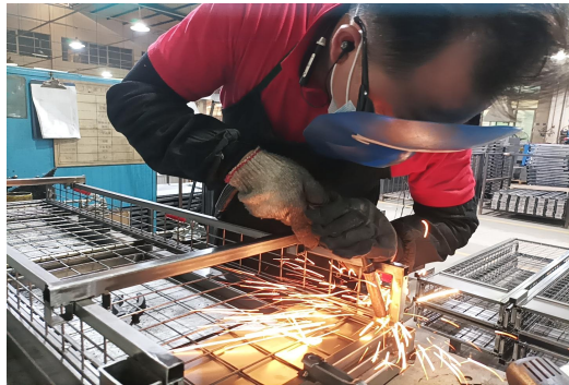
CO 2 MIG Welding *10
