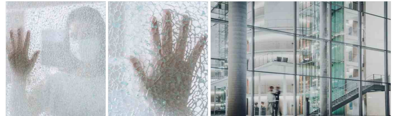
Glass Broken Test 夹胶玻璃破碎的呈现
