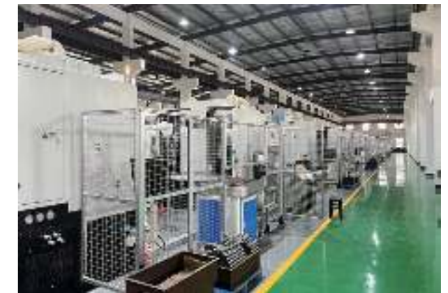
2022 第二代生产线 (数据监测、刀具自动补偿) 2022 Second Generation Production Line (Data Monitoring, Automatic Tool Compensation)
