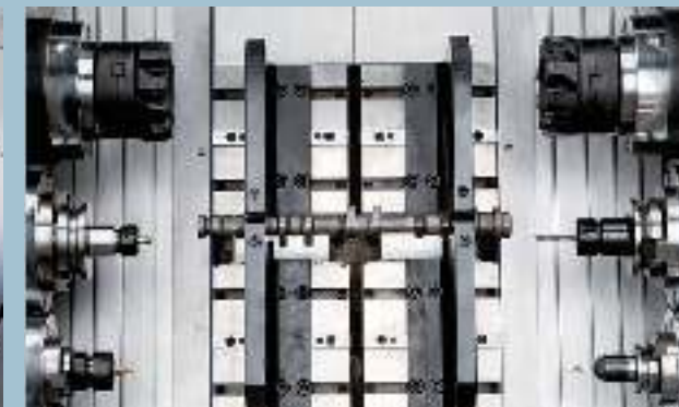
KPD/JXZ 系列铣钻攻一体三主动力头，适用于铣端面打中心孔、钻孔攻螺纹为一体，自定心夹具，锻打类圆钢类特殊形件加工，加工直径在150以下。
