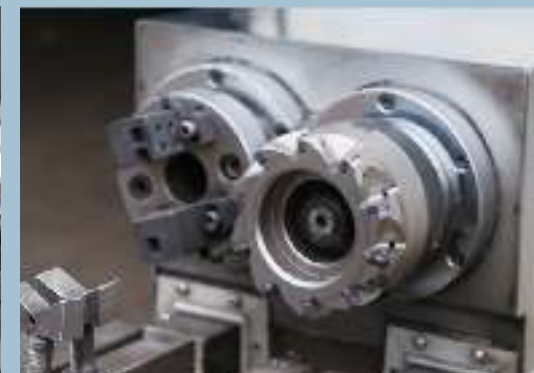
JX-Z500系列平床身系列单 / 双主轴适合直径50以下铣单面打中心孔铣端面打中心孔镗孔。
