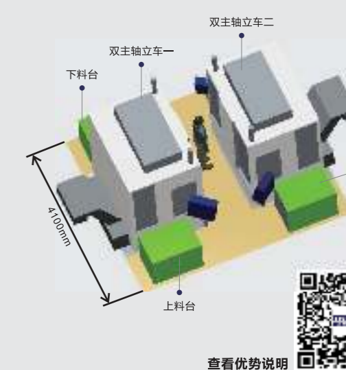
图四 双轴立车四台联机示意图及优势说明
