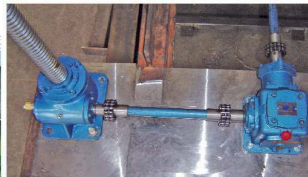
转向箱与丝杆升降机现场使用 Field use of gearbox and screw jack
